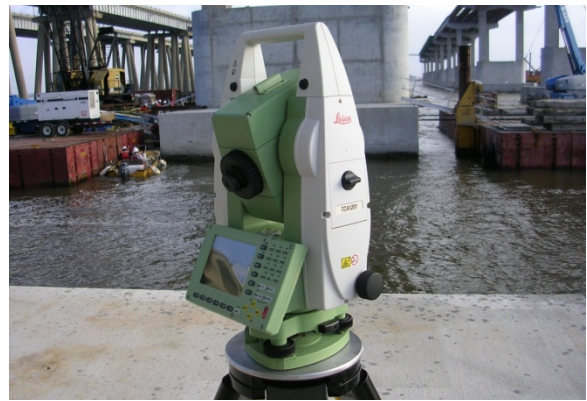
(d) Automated laser survey
