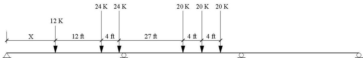
(d) Case 4 GVW=120 Kip with Max Tandem Load 48 Kip and Max Tridem Load 60 Kip
